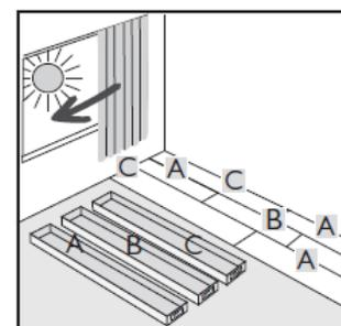
Beginnen Sie mit der Verlegung gemäß Verlegeplan in der linken Ecke der längsten Raumwand oder aus der Mitte heraus (abhängig vom Verlegeverband). Wenn Sie die Verlegung an der Wand beginnen, starten Sie mit der Federseite zur Wand und entfernen die Feder. Bereiten Sie für die Verlegung die ersten drei Verlegereihen vor. Legen Sie diese trocken aus, um ggf. Anpassungen zur angrenzenden Wand vorzunehmen.
