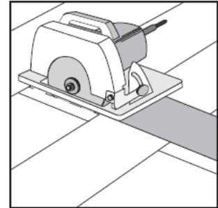
Trennen Sie vom einzusetzenden Element die Feder der Längs- und Stirnseite ab. Kontrollieren Sie im trockenen Zustand die Passung des Elements in der Aussparung. Arbeiten Sie ggf. mithilfe von Schleifpapier und/oder Handhobel entsprechend nach. Anschließend kleben Sie das neue Element mit geeignetem Klebstoff in die Aussparung. Fugen können anschließend mit geeignetem Reparaturkitt kaschiert werden.
