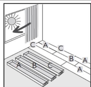
Schneiden Sie die Elemente der letzten Reihe auf Maß. Das Zusammenfügen der Nut- / Federverbindung der Längsseite kann mit Hilfe von Zugeisen oder ähnlichen Hilfsmitteln unterstützt werden. Berücksichtigen Sie hierbei auch den einzuhaltenden Randabstand.
