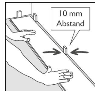
Ziehen Sie bei der weiteren Verlegung abschnittsweise den Klebstoff nach Herstellerangaben vor und fügen Sie anschließend die nächsten Elemente exakt zusammen, indem Sie die Elemente mit leichtem Druck in das Kleberbett legen und in die Nut- und Feder-Verbindung schieben. Hierbei kann der Einsatz eines Schlagklotzes hilfreich sein. Das Reststück einer Reihe kann als Anfangselement der zweiten Reihe eingesetzt werden.
