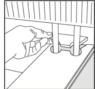
Türen: Markieren Sie mittels Elementabschnitt oder anhand eines gedrehten Panels die Schnittmarke an der Türzarge. Passen Sie die Türzarge mit geeignetem Werkzeug entsprechend an.
