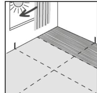
Halten Sie bereits bei der ersten Elementreihe und anschließend zu allen weiteren aufsteigenden Bauelementen (Wände, Säulen, Heizungsrohre etc.) mindestens 10 mm Abstand. Nichtbeachtung führt zu einem eingespannten Zustand der Konstruktion. Dies führt zu Aufwölbungen im Bodenbelag und in der Folge ggf. zur Zerstörung des Bodenbelags.
