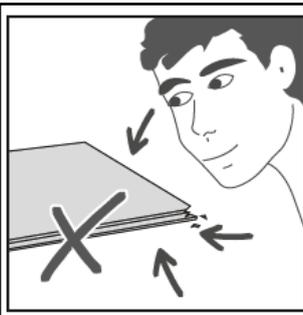
Während der Verlegung die Elemente aus mindestens drei oder mehr Paketen und auf Materialfehler überprüfen. Elemente mit sichtbaren Materialfehlern dürfen nicht verlegt werden.
