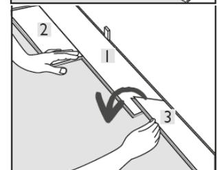
Das Verriegeln der Stirnverbindung geschieht grundsätzlich unter Zuhilfenahme eines Schlagklotzes und eines Hammers.
