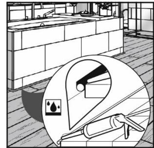
Beginnen Sie mit der Verlegung gemäß Verlegeplan in der linken Ecke der längsten Raumwand.
