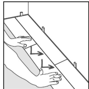
Zusätzlich haben Sie die Möglichkeit, nach dem längsseitigen Einwickeln die stirnseitige Verbindung durch leichtes horizontales Einklopfen mittels passenden Schlagklotz zu verriegeln. Klopfen Sie von der freien Stirnseite in Richtung des bereits liegenden Elements. Achten Sie hierbei darauf, dass die Höhenlage der Elemente zueinander passt.
