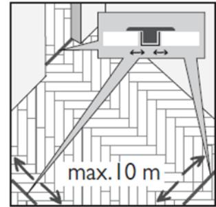
Eine Fixierung der schwimmenden Konstruktion durch schwere Gegenstände, wie Küchenzeilen, Öfen, Aquarien, Wasserbetten etc. muss vermieden werden. Ist dies unvermeidbar, muss der Bodenbelag sich von der Fixierung ausgehend frei in alle verbleibenden Richtungen ausdehnen können. Bei Nichtbeachtung kann es u.a. zu Fugenöffnungen kommen, sicher aber zu einem unbefriedigenden Gesamteindruck.
