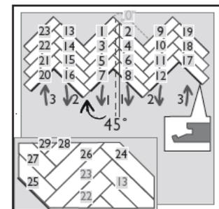
Gehen Sie für die Verlegung der ersten 4 Reihen gemäß des im Bild angegebenen Schemas vor. Erweitern Sie die die Zöpfe im selben Schema nach links und rechts, bis keine ganzen Elemente mehr verwendet werden können.
