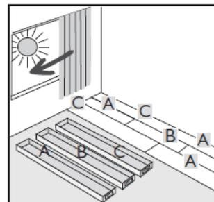
Legen Sie zunächst die Wand fest, von welcher Sie mit der Verlegung beginnen möchten. Von dieser Wand ausgehen ermitteln Sie die Raummitte und markieren die Verlegelinie 45 mm (ein Viertel der Deckbreite eines Elements) rechts der Raummitte.
