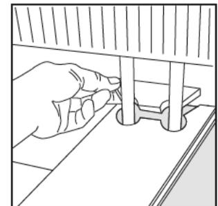
Türen: Markieren Sie mittels Elementabschnitt oder anhand eines gedrehten Elements die Schnittmarke an der Türzarge. Passen Sie die Türzarge mit geeignetem Werkzeug entsprechend an.
