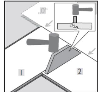
Anschließend winkeln Sie die Längsseite des Elements 2 in die Längsseite des Helferelements „0“ ein. Schieben Sie Element 2 in Richtung des Elements 1 bis die Stirnseite des Elements 2 passend über der Längsseite des Elements 1 steht. Drücken Sie Element 2 hinab bis die Verbindung zwischen Element 1 und 2 entsteht. Die endgültige Verriegelung zwischen Element 1 und 2 erfolgt wie zuvor beschrieben unter Zuhilfenahme eines Schlagklotzes und eines Hammers.
